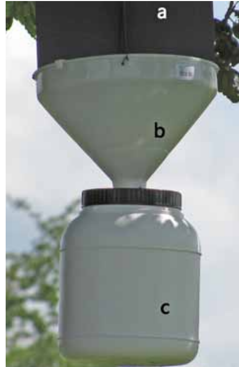
Ryc. 13. Pułapka feromonowa do odłowu pachnicy. Składa się ona z dwu czarnych ekranów 25 x 20 cm (a) połączonych za pomocą nacięcia pod kątem prostym, osadzonych w lejku o średnicy 25 cm (b), który prowadzi do pojemnika przetrzymującego schwyte owady (c). Fot. A. Oleksa
