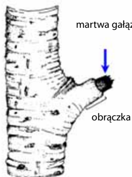
Rys. 6. Cięcie martwej gałęzi na obrączkę („Illustrated guide to pruning, second edition” by E. F. Gilman, Delmar Publishers, Albany, NY, 330 pgs)
