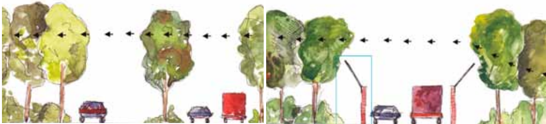
Ryc. 6. Utrzymanie szpaleru drzew pomiędzy dwoma pasami ruchu w miejscu przelotu nietoperzy lub założenie specjalnych ekranów powinno zapobiegać wlatywaniu tych zwierząt na drogę. Rys. B. Kokurewicz
