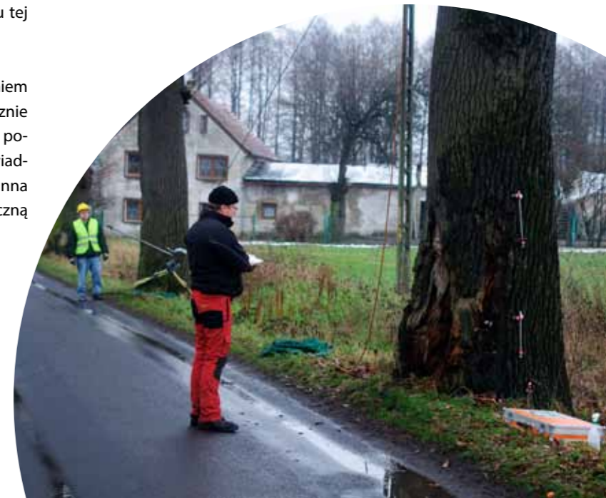
Badanie wnętrza drzewa za pomocą tomografu dźwiękowego.
