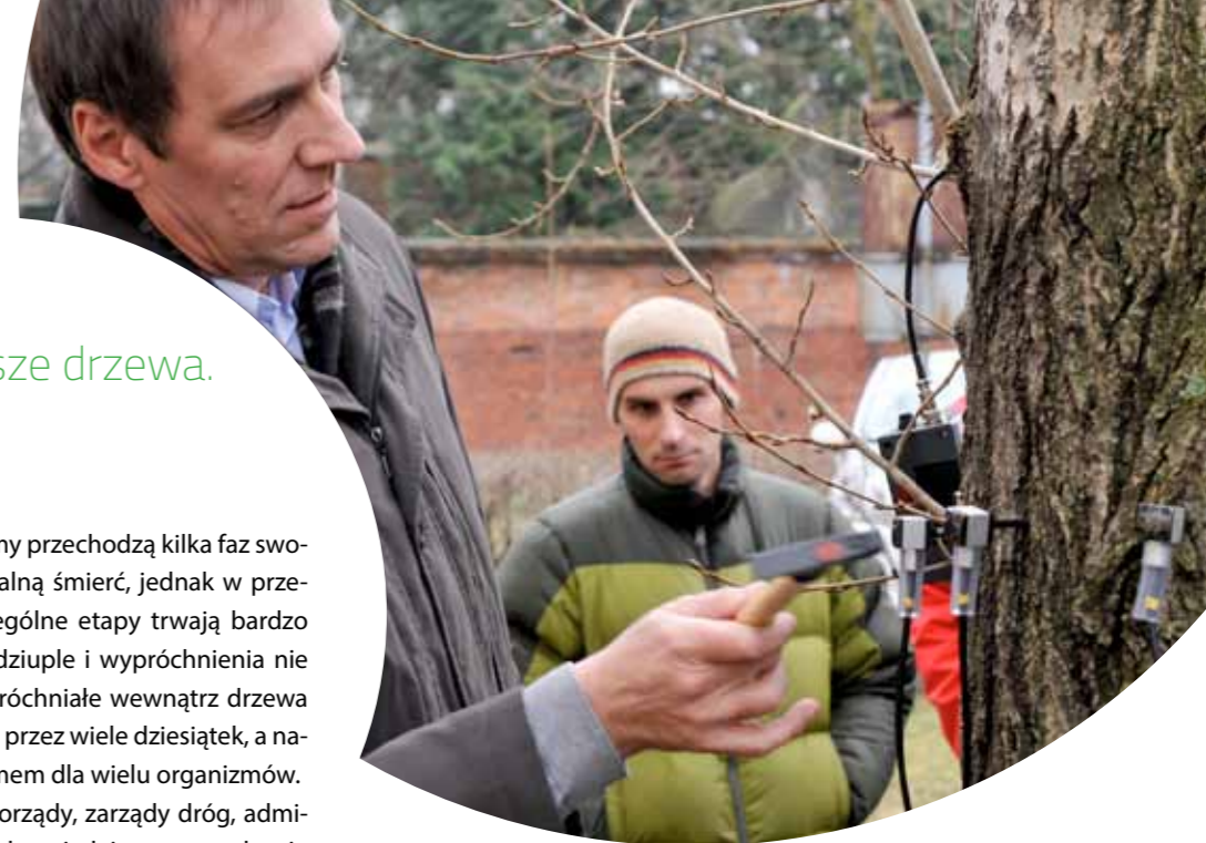
Badanie wnętrza drzewa za pomocą tomografu dźwiękowego.
